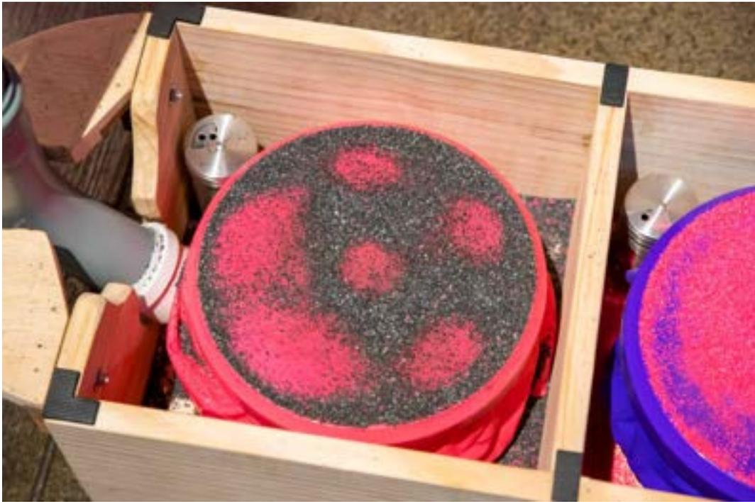
Figura 23 - Área 3 - Som - Figura formada por uma vibração.
