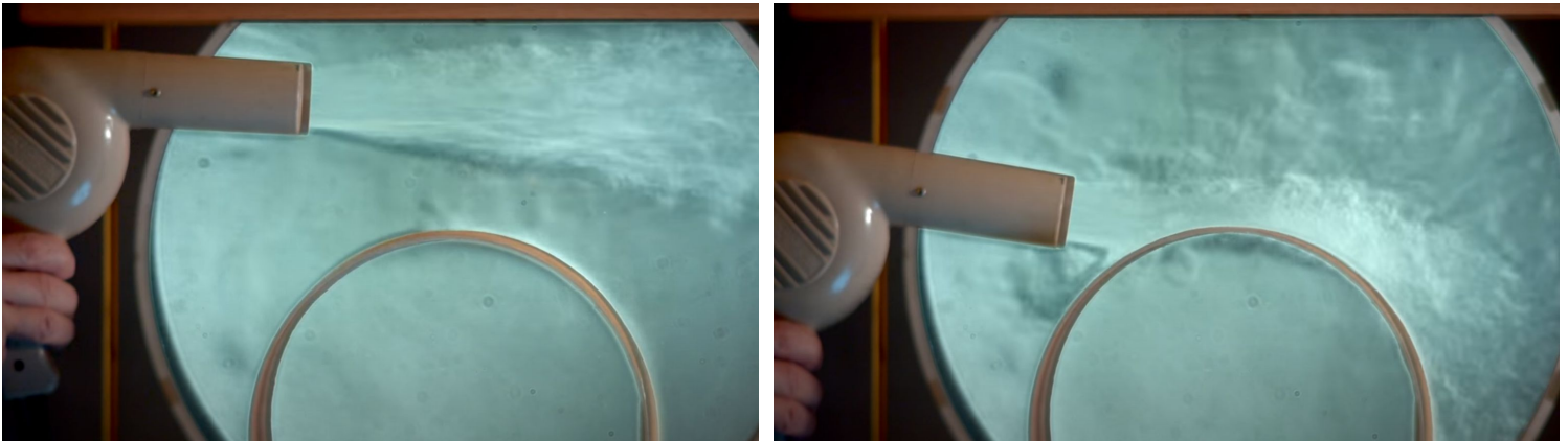
Figs. 1 e 2: Trajetória do ar soprado pelo secador, a certa distância da superfície curva e próximo o suficiente para que o ar se encoste na dita superfície, respectivamente
