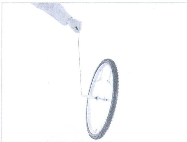
Figura 3 - Eixo de rotação do giroscópio a 90°. Cedido pelos laboratórios Cidepe.
