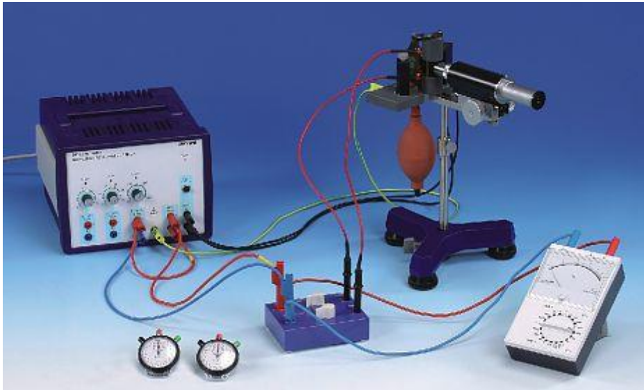
Figura 1- Aparato de Milikan para determinar a carga do elétron
